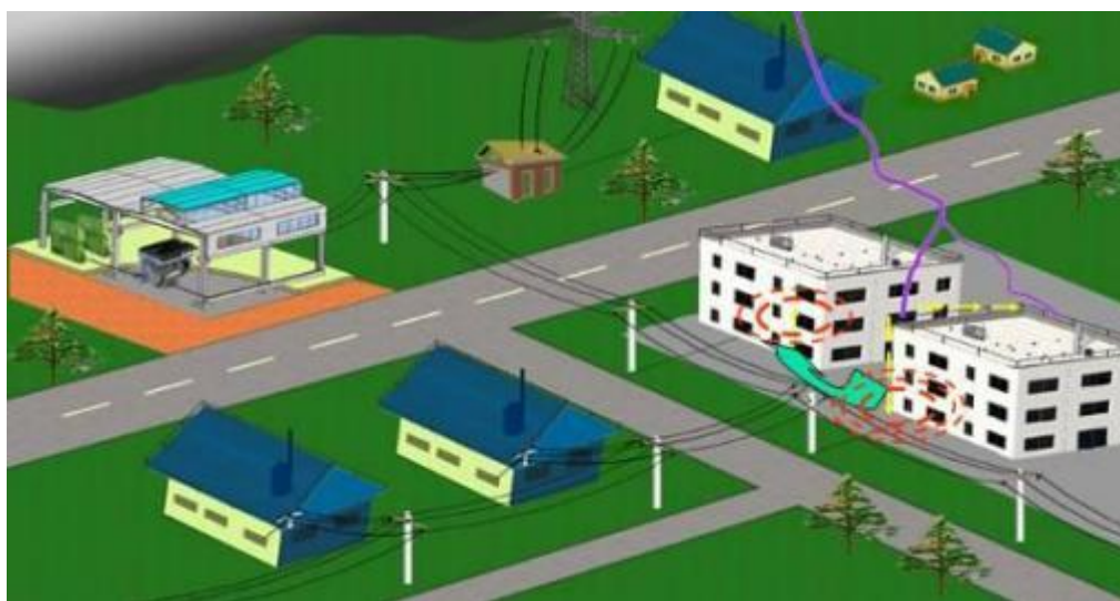
图3.2-4 雷击引起的电磁感应与耦合示意
