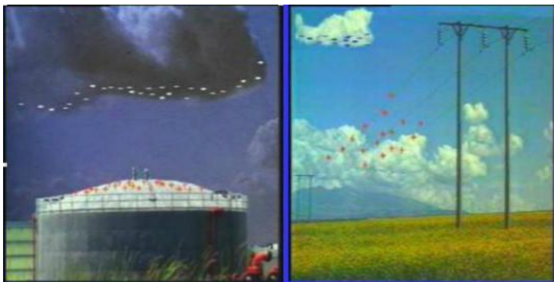
图3.2-5 静电感应示意图
